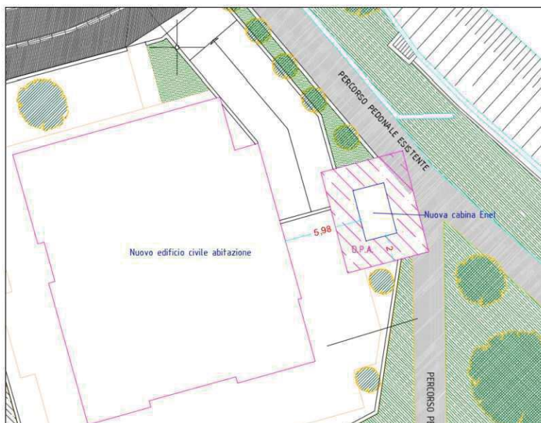
Figura 3: Distanza di prima approssimazione per la cabina di nuova realizzazione e pianta del nuovo fabbricato.
