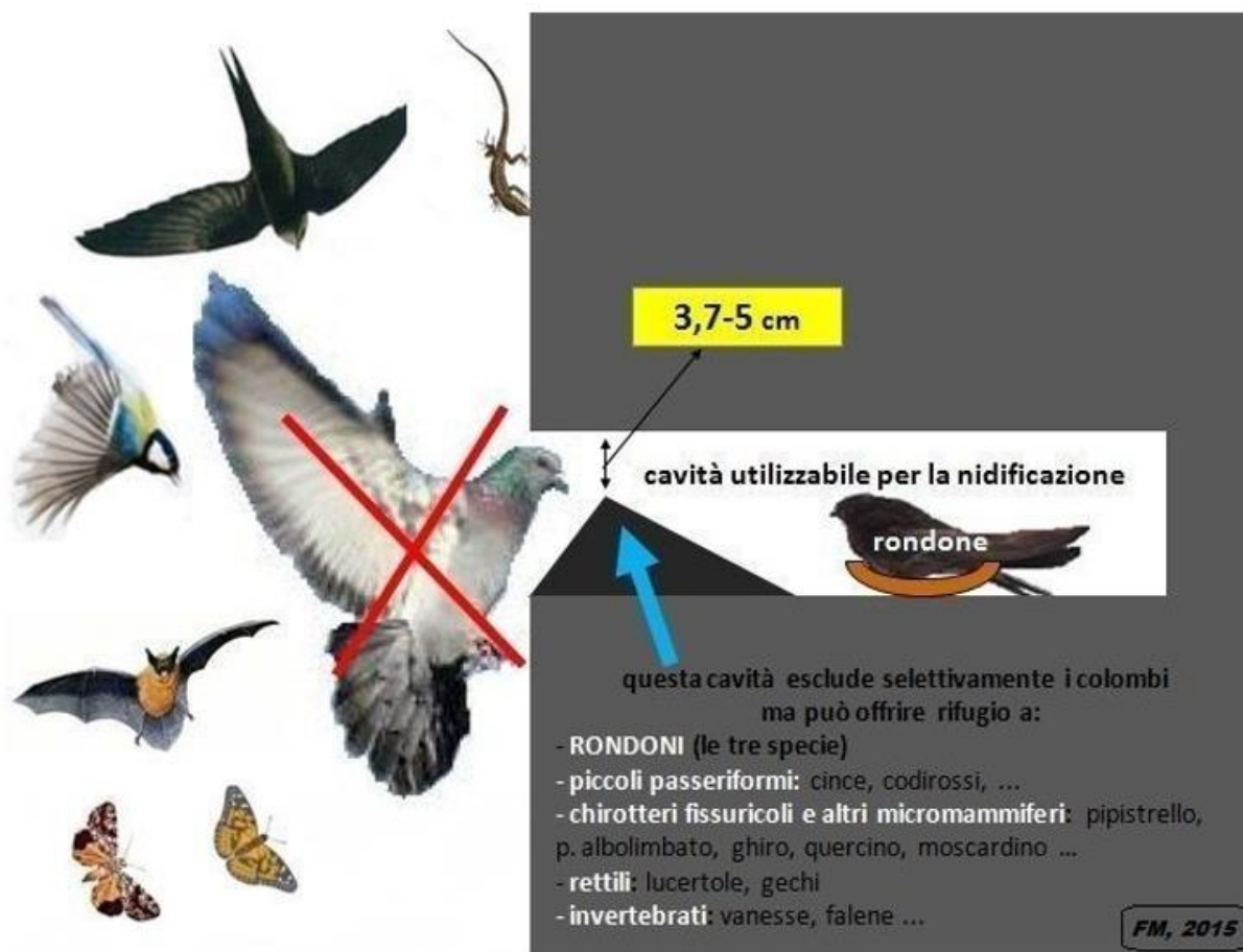
Figure 27 – Riduzione selettiva dell’entrata delle buche pontale: schema di funzionamento del manufatto di cui alla figura precedente (da: Ferri et al., 2015)
